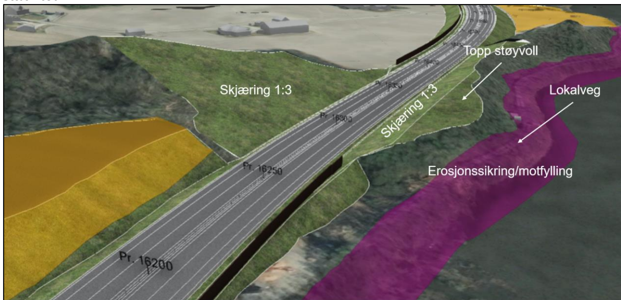
Figur 7-9: Stabilitet ved Forset. Skjæring i vest, skjæring og støyvoll i øst. Erosjonssikring langs elv. (Kilde: Norconsult).
